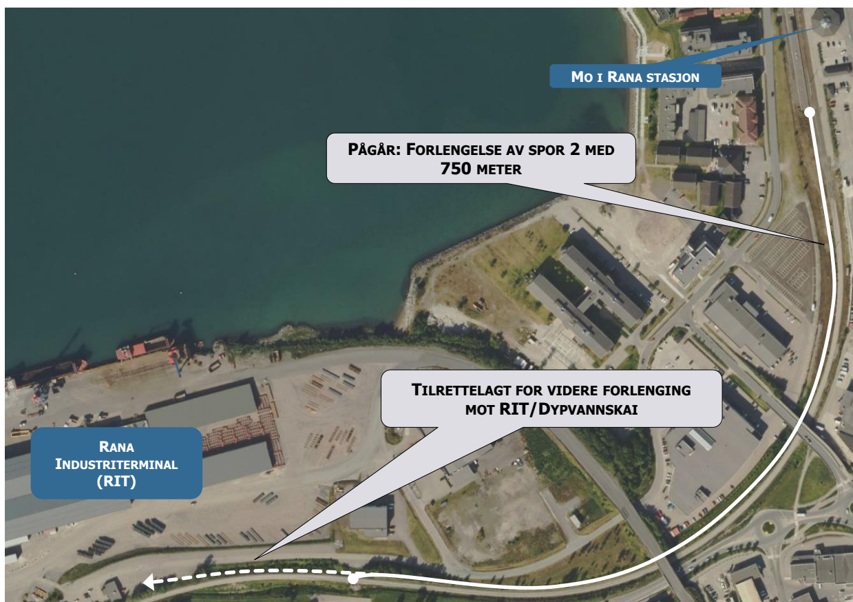
Figur 3-13: Forlengelse av kryssingsspor Mo i Rana stasjon
